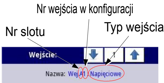
Rys. 7.79. Sposób zapisu Nazwy wejścia wbudowanego
