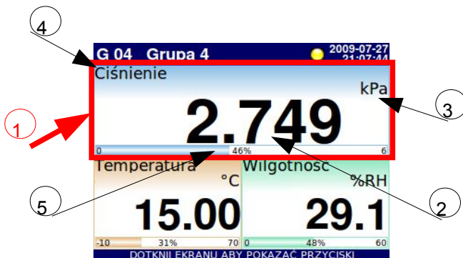
Rys. 6.5. Struktura Panelu pomiarowego
